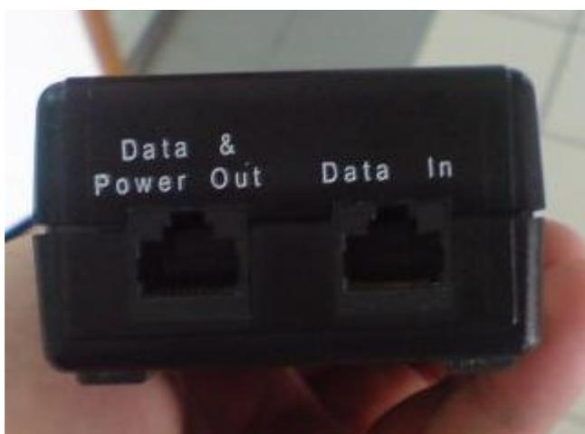
“Data In”則是連接有線網路的接孔，同樣使用 RJ45 網路線。BS 可接上 Internet，SS 則可以連上 AP 等設備。在做設定時，則用此一接孔連上一台 PC 或筆記型電腦，但要注意此電腦的有線網路介面是否支援連結 WiMAX 的設備。
