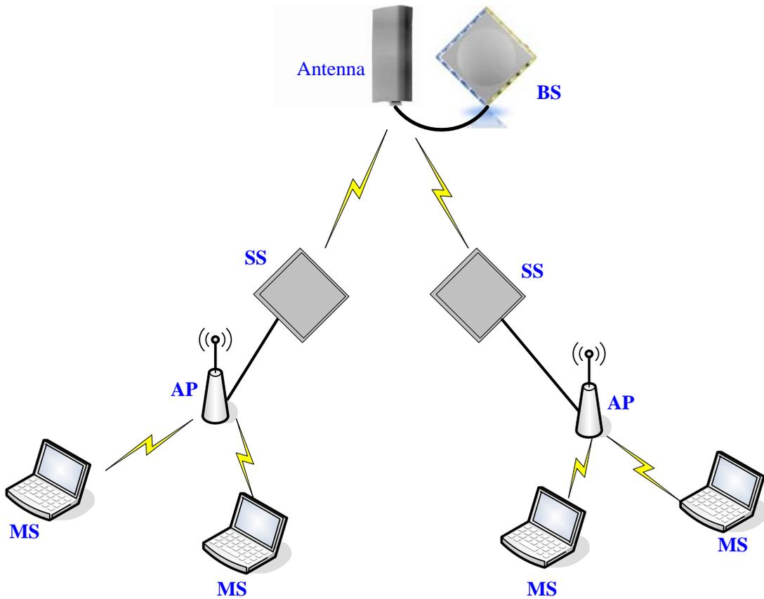
單一的WiMAX網路是以BS為中心，如圖的最上方就是一台BS及它的外接天線。BS之下以無線連結多台SS，每台SS能以有線方式連接一台AP，而MS則利用AP連結整個WiMAX網路上的其他MS。
